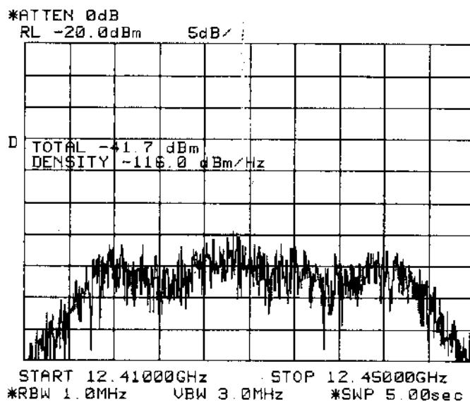
Slika 1) MMDS Mengoš (oddajnik Ambrož), V polarizacija - moč v pasovni širini 27 MHz
